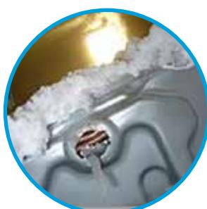
Kältemitteldurchlauf durch Bodenplatte und Wärmetauscherboden
